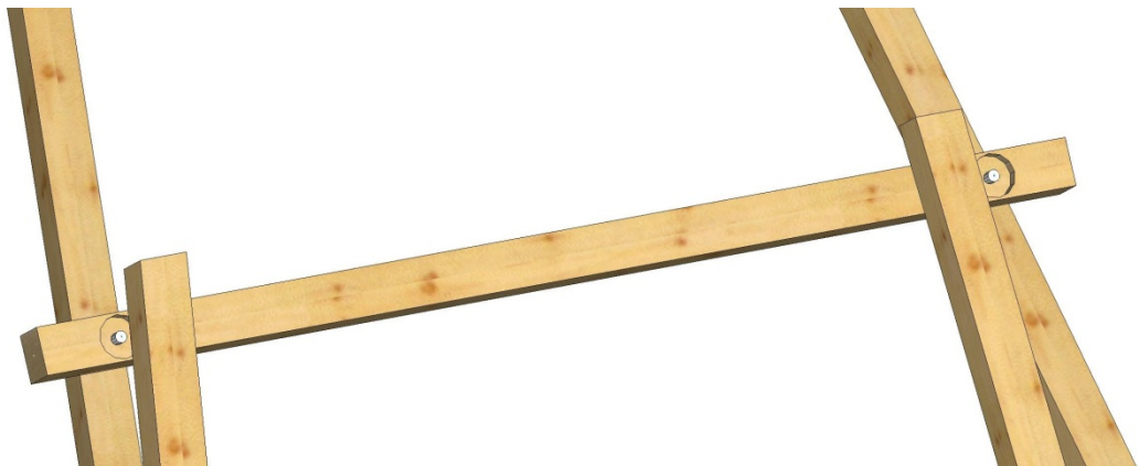
Fig. 18 : Détail boulonnage arches
