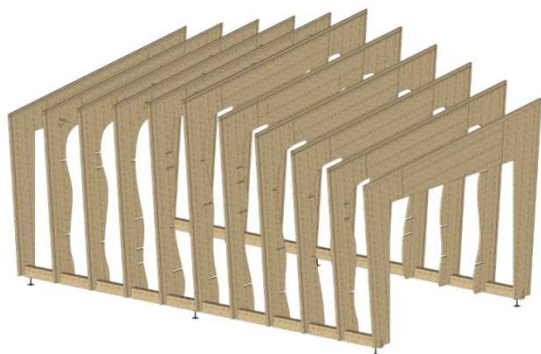
Perspective de la succession des arches posées sur la lisse basse
