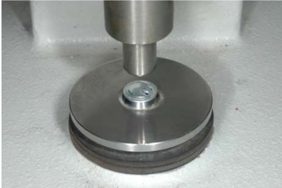
Figure 10: Sertissage d'un creuset
