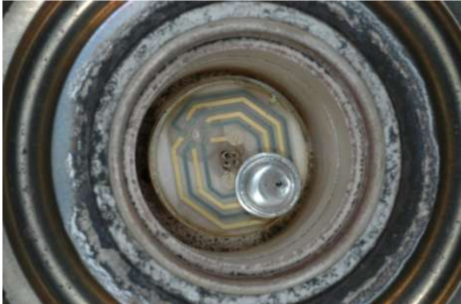
Figure 12: Chambre du calorimètre avec le creuset de référence en place, l'emplacement pour le creuset de travail est libre
