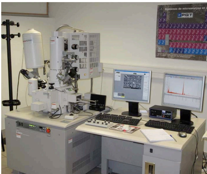
Figure 10 : Microscope électronique à balayage Hitachi® FEG S-4800
