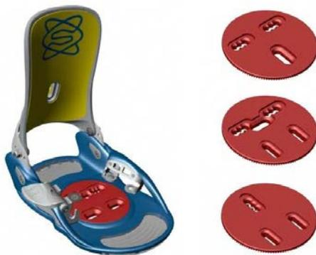
SolidWorks permet la création et la gestion de configurations de produits et d'assemblages depuis le modèle original, comme montré dans l'exemple ci-contre illustrant une gamme de fixation de snowboard.
