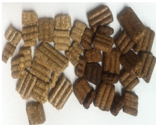
Figure 31 : Granulés de paille avant et après torréfaction
