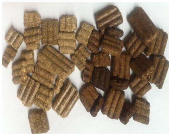
Figure 31 : Granulés de paille avant et après torréfaction
