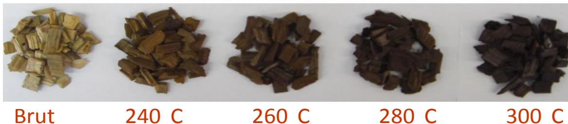
Figure 3 : Photo de pin torrifié à différentes températures
