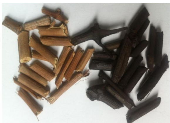
Figure 32 : Sarments de vigne avant et après torréfaction
