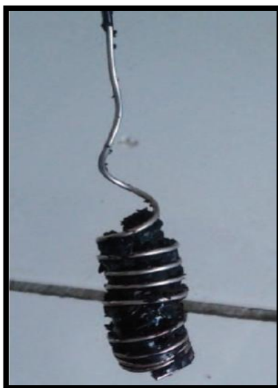
Figure 8 : Fil utilisé pour la mesure du temps de gel.
