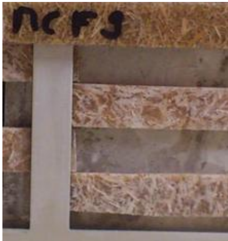
Figure 13 : (gauche) Différence d'aspect entre témoin (haut) et échantillons vieillis (milieu et bas) après un cycle ; Photographie MEB de la surface d'un composite non traité après QUV
