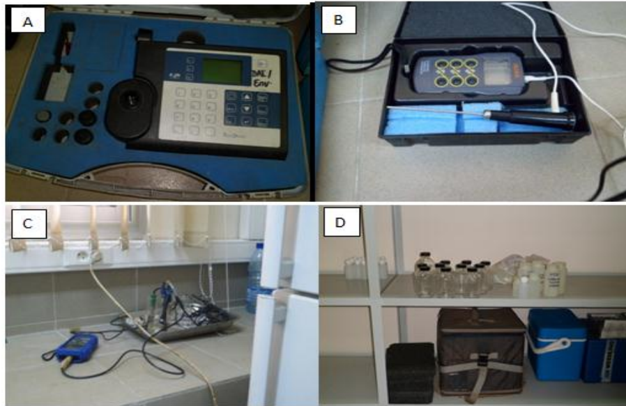
Figure 12 : L'appareillage : A-turbidimètre, B-sonde à température, C-pH-mètre et D-flaconnage
