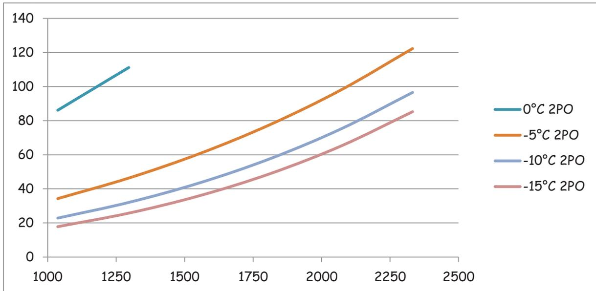
**Graphique III.B.6.a)-2:** « Évolution de la puissance absorbée en fonction de la puissance frigorifique disponible pour différentes températures extérieures avec 4 pompes en fonctionnement ».
