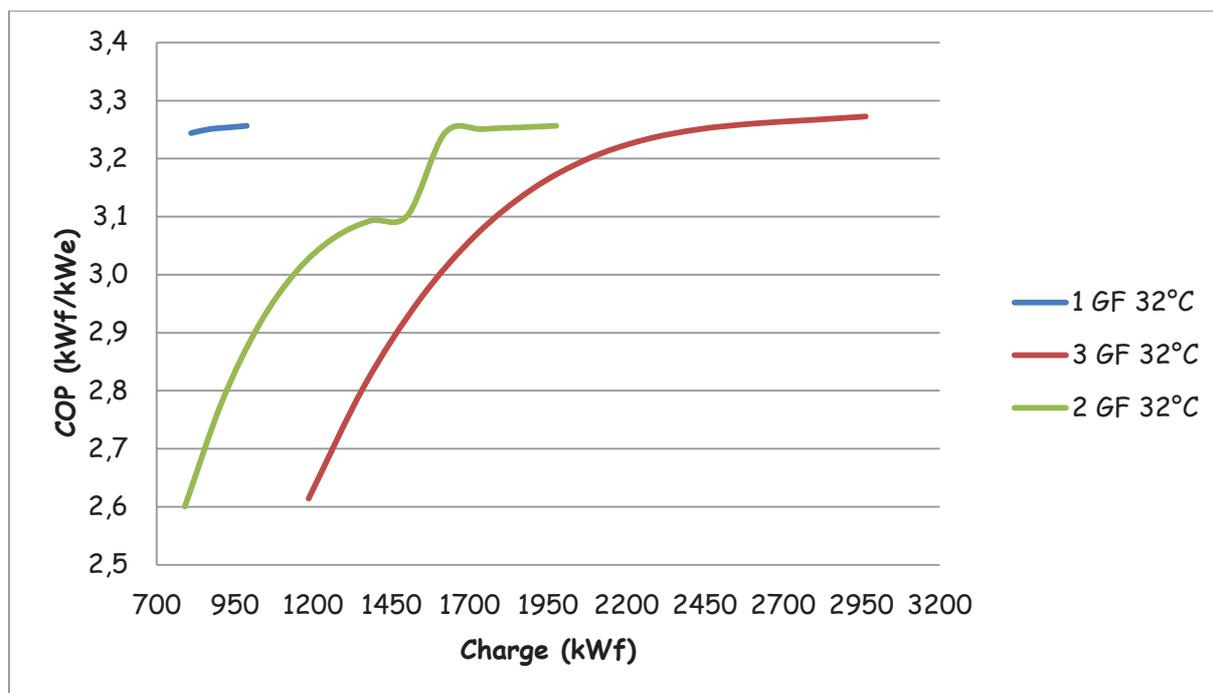
Comme déjà exprimé en 1.), la fluctuation de COP pour 2 groupes enclenchés est due au démarrage d'une deuxième pompe de stockage permettant de diminuer la puissance absorbée.
