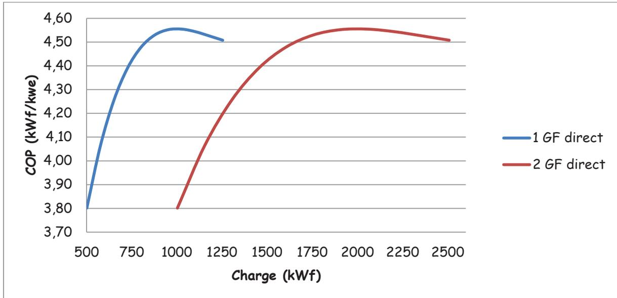
**Graphique III.B.3.a).2)-2** : « Évolution du COP de la production direct en fonction de la charge appelée, pour une température retour au condenseur égal à 32°C ».
