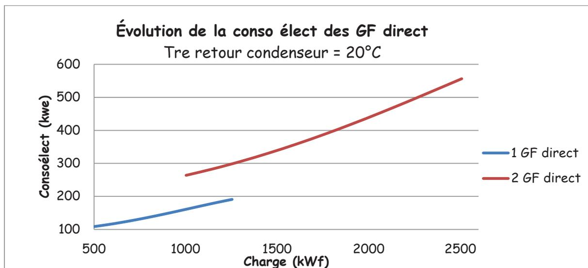
On constate clairement que les performances thermiques de la production directe sont nettement supérieures à basse température : pour deux groupes à pleine puissance : l'écart de puissance absorbée est d'environ 54 kWe entre une température d'entrée condenseur de 32 et 20°C.
