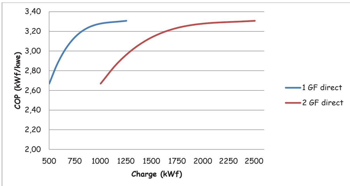
On remarque que l'optimum des performances à 20°C de température entrée évaporateur est décalée et le correspond pas au maximum de la charge appelée comme à 32°C.
