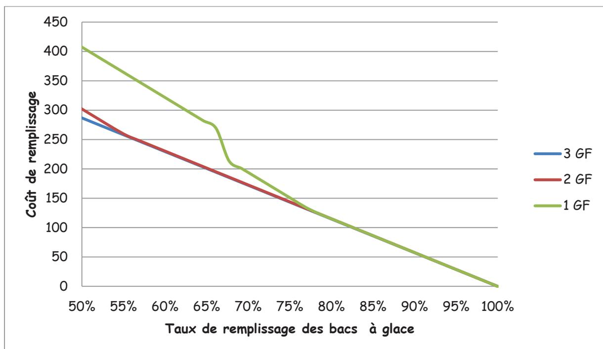
Le temps mis au stockage d'un seul groupe en fonctionnement n'est pas du tout intéressant face à 2 ou 3 groupes en marche. Néanmoins, vers 75% de la capacité des bacs, l'ensemble de ces combinaison s'équivalent. En effet, cela s'explique facilement du faite des performances énergétiques similaire et de la capacité à remplir les bacs pendant les heures creuses. Cette conclusion est applicable pour la comparaison des courbes 2 et 3GF.
