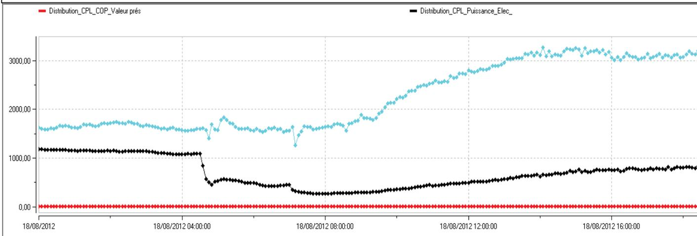
**Graphique V.E-2) :** « GTC TRANE- Évolution de la puissance froid et électrique du 18 /08/2012 au
