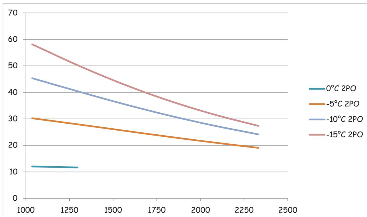
**Graphique III.B.6.b)-2** : « Évolution de la puissance absorbée en fonction de la puissance frigorifique disponible pour différentes températures extérieures avec 4 pompes en fonctionnement».
