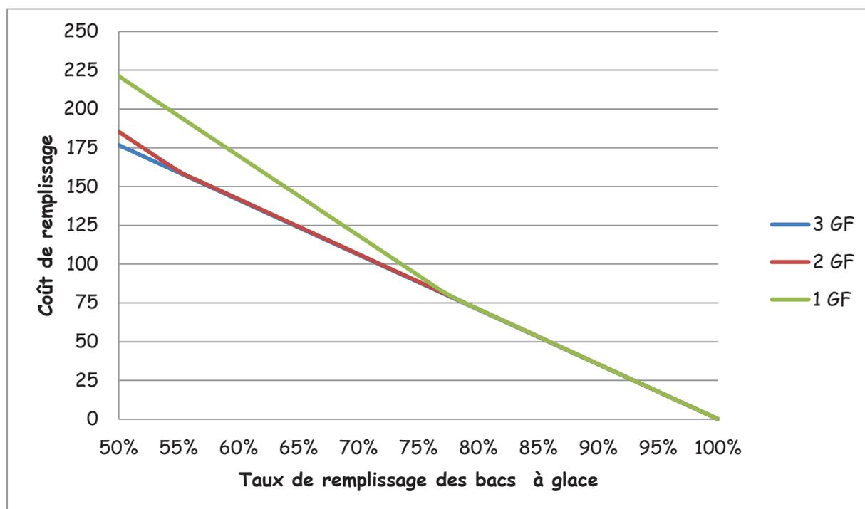
On remarque que pour une tarification électrique en été, on diminue de 200€ le coût du stockage de 50% de la capacité des bacs. De plus, on remarque que le seuil de performances similaire est toujours d'un départ de 75%.
