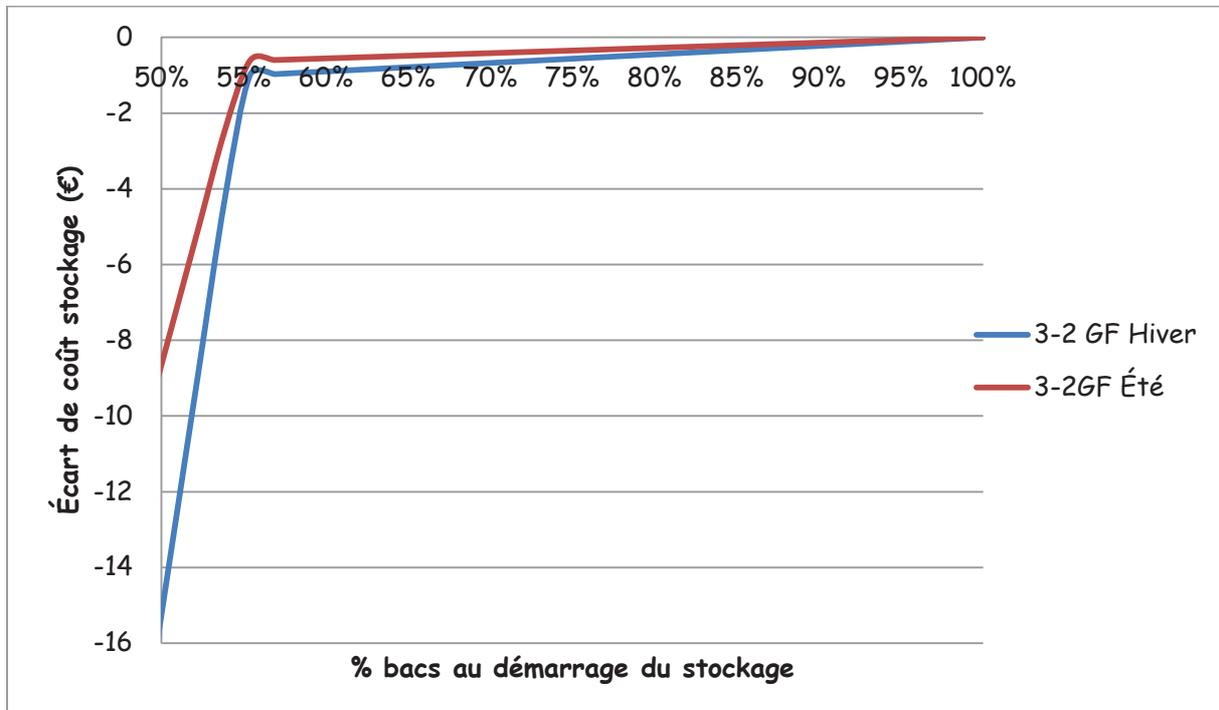
**Bilan stockage:** Le stockage avec 2 groupes froid n'a aucun sens car la puissance souscrite n'est pas imposée par la puissance électrique absorbée par le stockage. De plus, le fait de stocker avec 3 groupes permet de diminuer le temps de stockage et donc de stocker un maximum de froid pendant les heures creuses.
