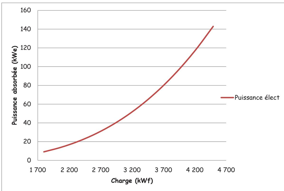
Le déstockage ne faisant appel qu'à des pompes, on remarque que l'évolution de la puissance absorbée est quadratique. Ainsi, il faudrait au maximum travailler sur des basses fréquences pour permettre d'optimiser les performances.
