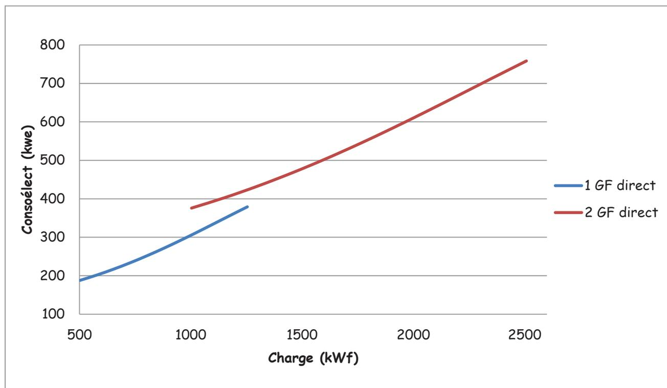
**Graphique III.B.3.a).1)-2** : « Évolution de la puissance électrique absorbée par la production direct en fonction de la charge appelée, pour une température retour au condenseur égal à 20°C».
