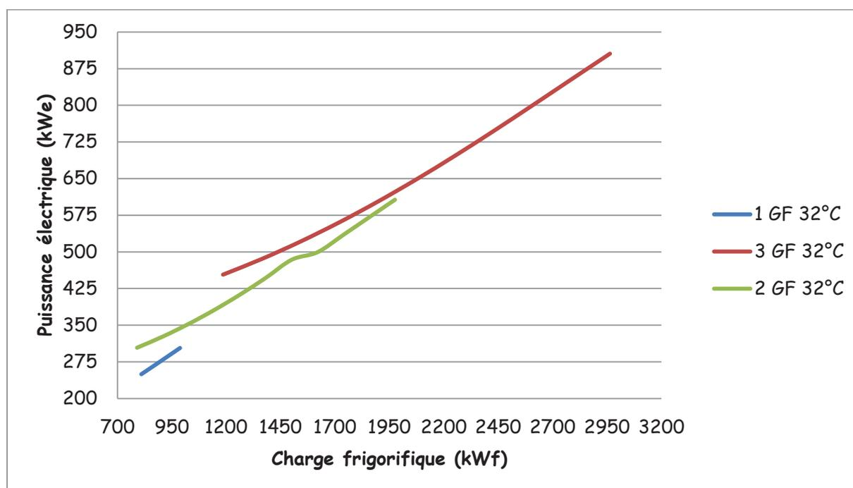
Pour que le débit du groupe froid corresponde au moins au minimum de débit admissible à 20 Hz d'une pompe de stockage, un groupe froid en fonctionnement ne peut fonctionner qu'à une puissance restreinte de son spectre. C'est pour cela que la courbe représentative du stockage avec un seul groupe froid est aussi petite.
