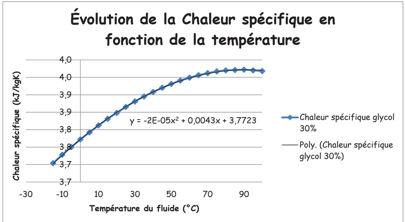
En retraçant les points de L'ASCAGEL 30%, j'arrive à en ressortir une courbe de tendance me permettant de faciliter le calcul du Cp moyen d'un régime de température.
