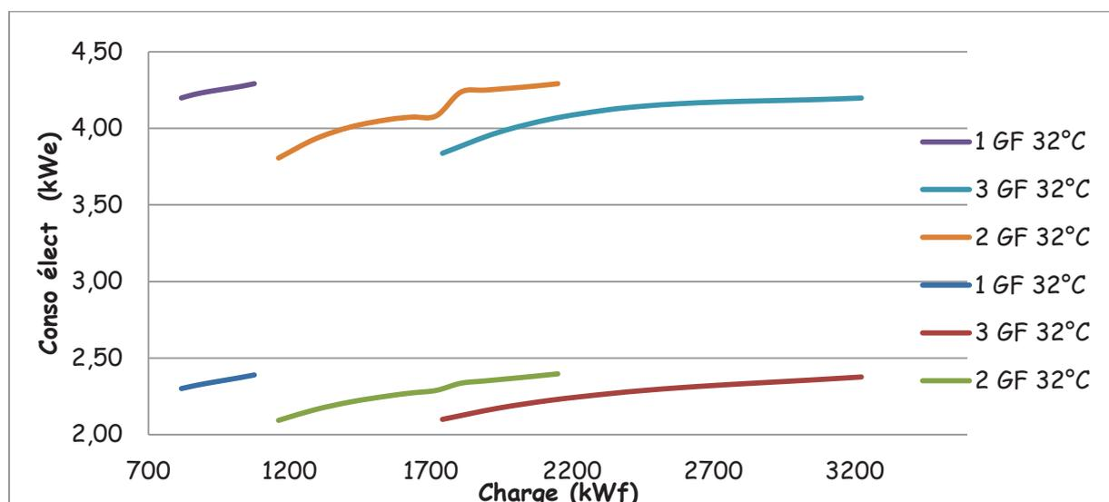
Le tableau suivant montre l'écart de COP entre un groupe à pleine charge frigorifique et un groupe supplémentaire à charge inférieure :
