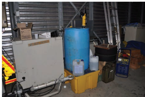
Zone de stockage sur bac de rétention
