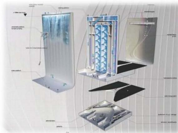
Et après le coucher du soleil, cette eau va être libéré du sommet de la tour (formant ainsi une sorte de chute d'eau) et va ainsi permettre de générer de nouveau de l'énergie renouvelable grâce à un système de turbines. Pendant la nuit, cette énergie renouvelable produite par la "chute d'eau", pourra être utilisée pour l'éclairage de la tour ou/et du village olympique.
