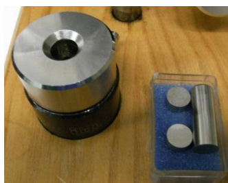
Figure 27 : Cylindre où l'on verse la poudre pour ensuite être pressé
