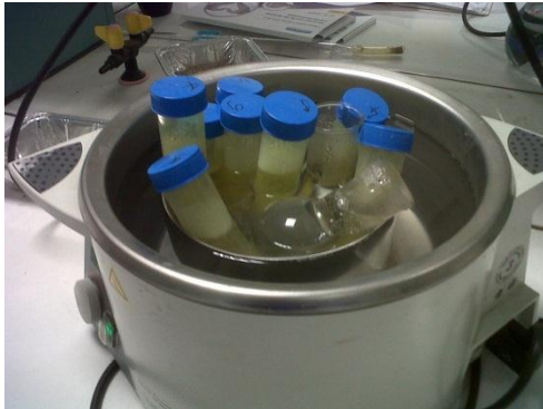
Figure 21 : Tubes réactionnels dans le bain marie
