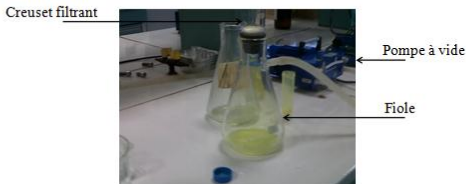
Figure 23 : Filtration du résidu
