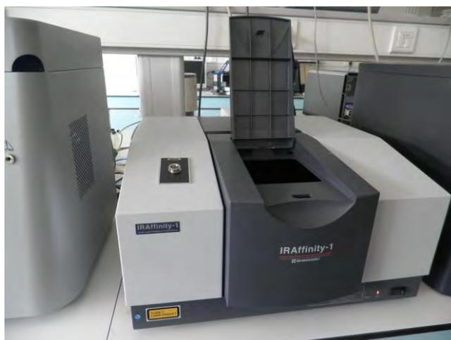
Figure 10 : Le spectromètre Infrarouge à transformée de Fourier du laboratoire du CRITT
