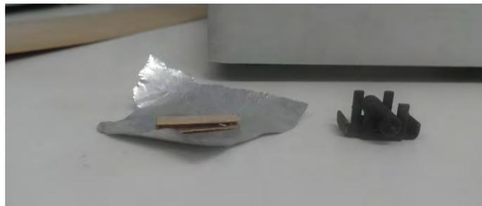
**Figure 12 : Un échantillon de résine avant sa mise en place dans l'appareil de TMA**
