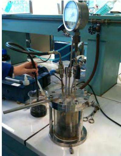
**Figure 3 : Autoclave utilisé lors de l'imprégnation de nos éprouvettes**
