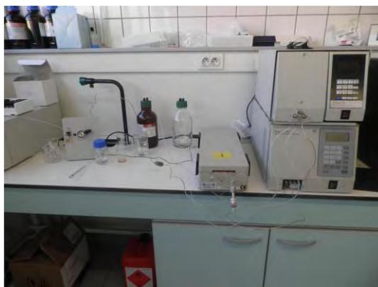
**Figure 7 : Chromatographe à perméation de gel du laboratoire du CRITT**
