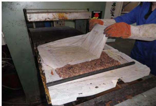
**Figure 32 : Panneau de particules en sortie de presse, réalisé avec une colle phénol-formaldéhyde standard**
