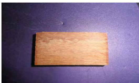
**Figure 29 : Éprouvette L3 imprégnée avec la résine phénolique basse viscosité**
