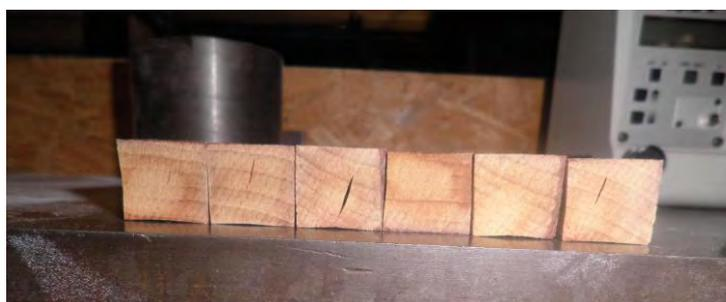
Figure 23 : Les éprouvettes du lot Phénolique HV vues en coupe transversale
