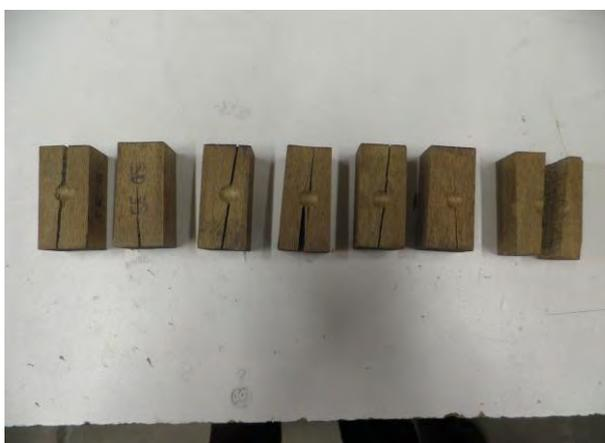
**Annexe 21 : Eprouvettes SD32 à SD38, imprégnées avec de la résine à base d'écorces prétraitées, fendues pendant le test de dureté**
