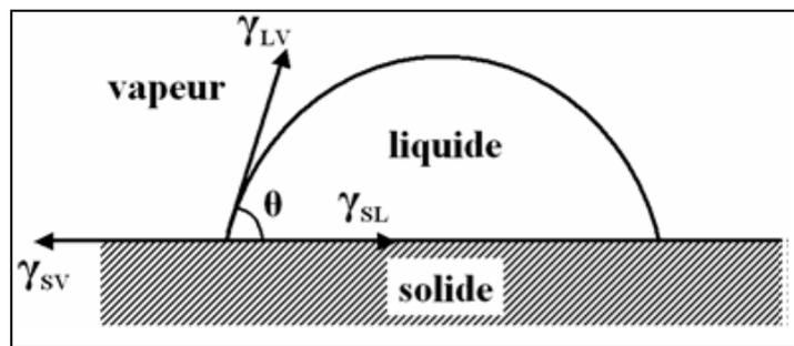
Figure 27 : Schéma montrant les grandeurs utilisées dans l'équation de Young-Dupré
