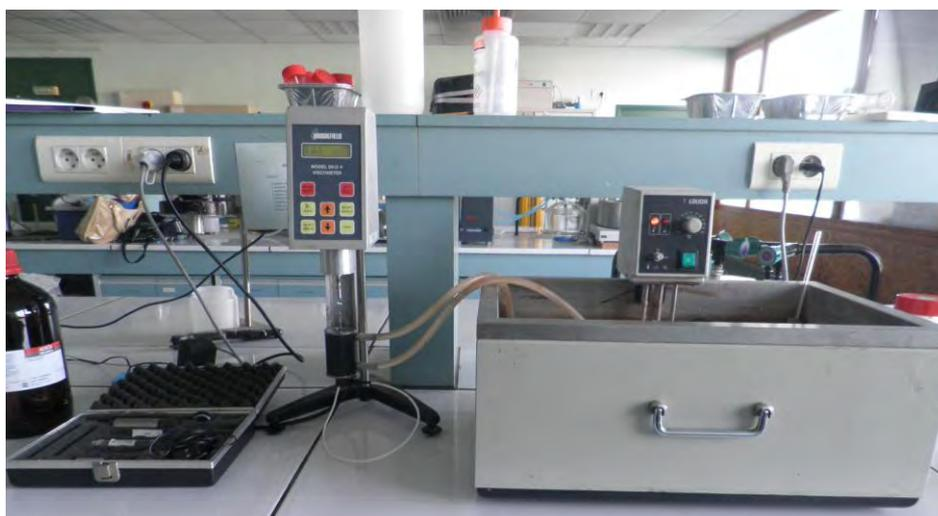
Figure 5 : Réalisation d'un essai de viscosité à 20 tours/mn et 25°C
