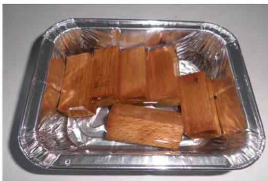
Figure 16 : les éprouvettes d'ASE pendant leur macération
