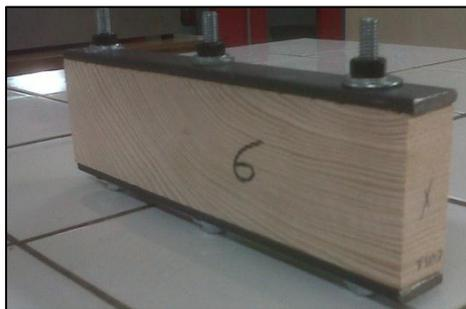
Image 7 : Photo d'un échantillon boulonné
