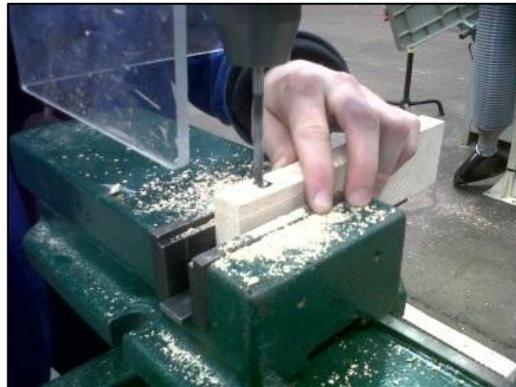
*Image 10 : Photo présentant le pré perçage des échantillons*
