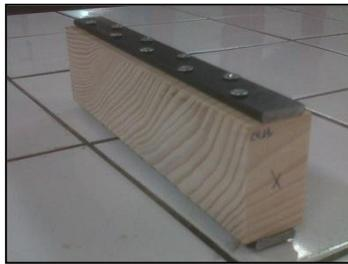
Image 6 : Photo d'un échantillon avec vissage en quinconce
