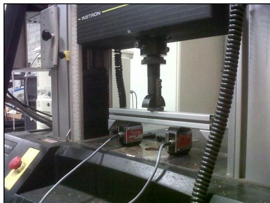
*Image 14 : Calibrage des cellules*
