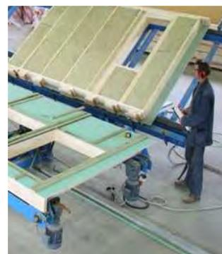
Figure 2 : Etape de finition (isolation, fermeture...)
