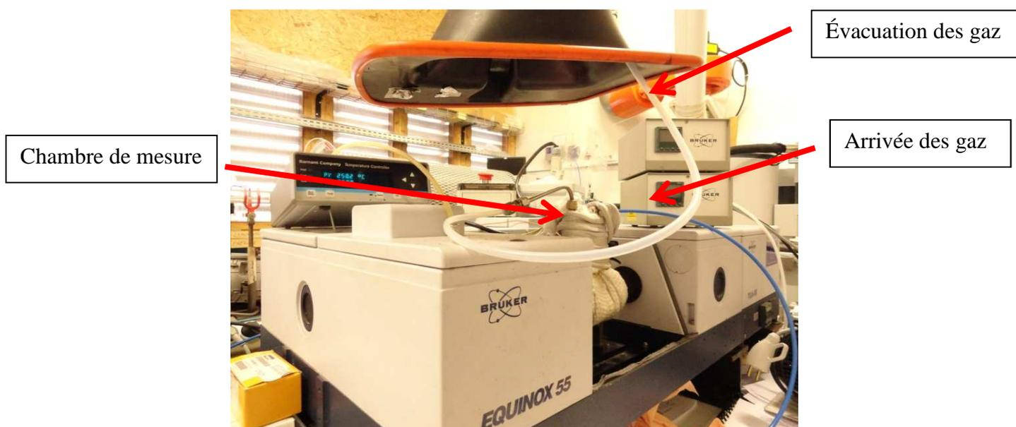
Figure 17 : spectromètre infrarouge à transformée de Fourier
