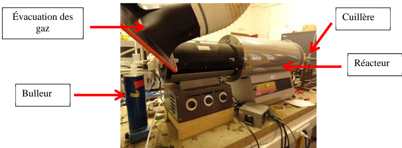
Figure 3 : montage expérimental de la pyrolyse
