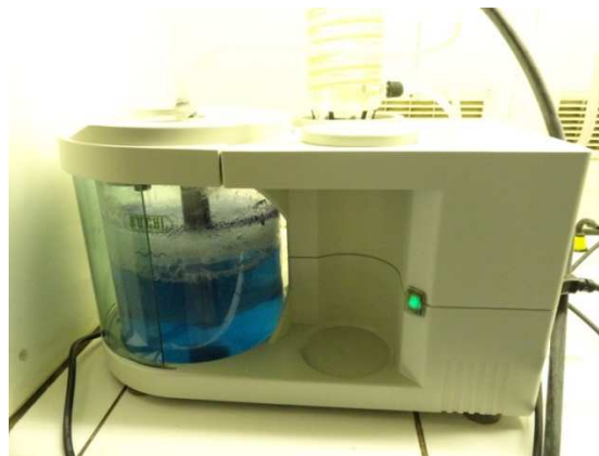
Figure 6 : Scrubber utilisé pour évacuer les gaz pendant la minéralisation
