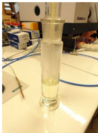
Figure 27 : aspect du condensat de pyrolyse avec utilisation d'eau comme solvant
