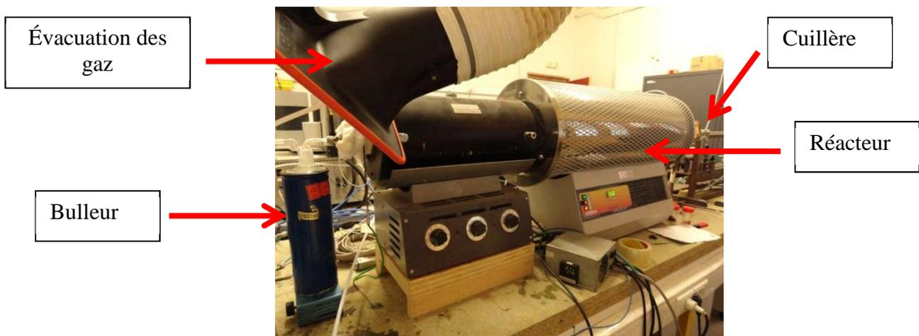
Figure 3 : montage expérimental de la pyrolyse
