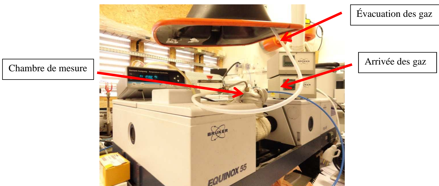
Figure 17 : spectromètre infrarouge à transformée de Fourier
