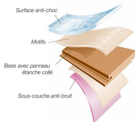
Figure 1 : composition d'un revêtement de sol stratifié vendu dans le commerce (source : Réso)
