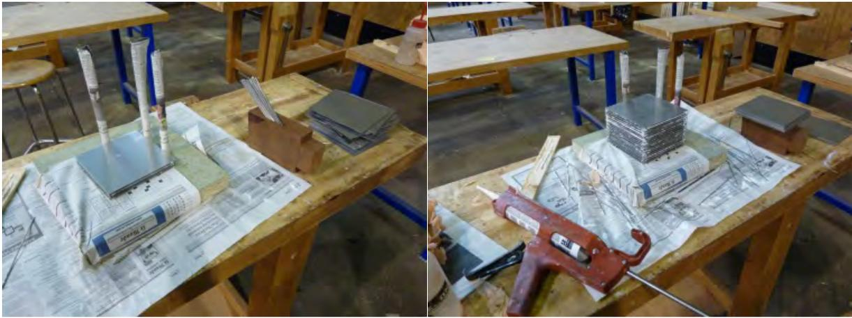
*Photographies 2 et 3 : Montage de l'échangeur à plaques*
