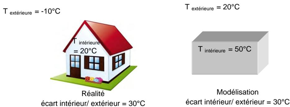
*Figure 9 : Modélisation des écarts de température*
