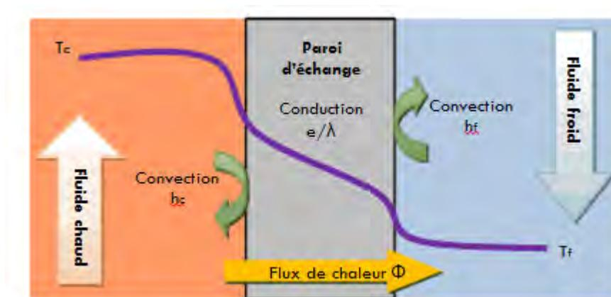
Figure 11 : Echange entre deux fluides séparés par une paroi plane
