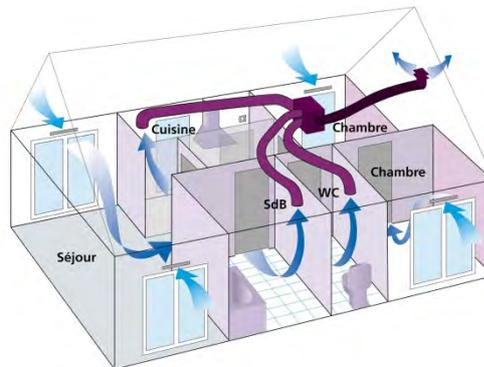
*Figure 3 : Schéma de fonctionnement d'une VMC simple flux [4]*
