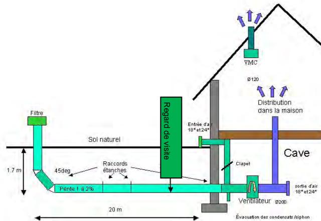
Figure 8 Schéma illustrant le fonctionnement d'un puits canadien [8]
