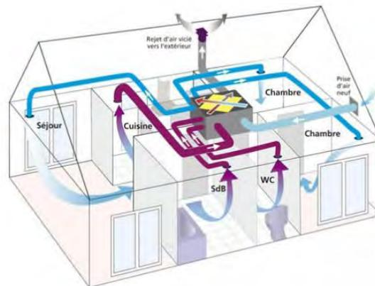
*Figure 4 : Schéma de fonctionnement d'une VMC double flux [4]*
