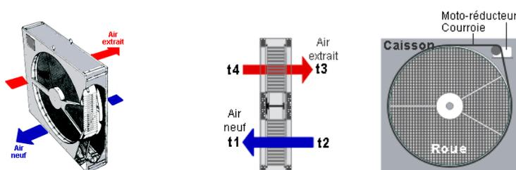
Figure 7 : Principe de fonctionnement d'un échangeur rotatif [5]
