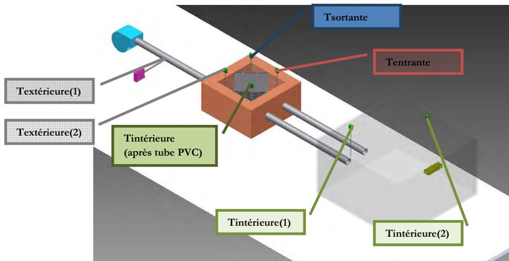
*Figure 16 : Position des relevés de température*
