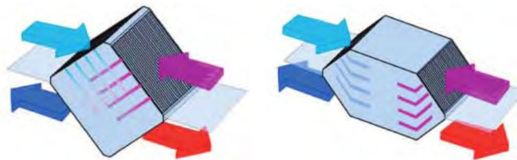
*Figure 6 : Comparaison échangeur à courant croisé (à gauche) et à contre-courant (à droite) [6]*
