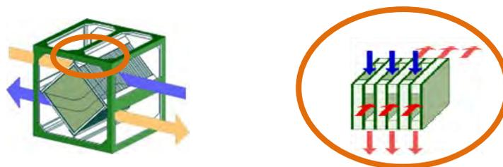
*Figure 5 : Principe de fonctionnement d'un échangeur à plaques [5]*
