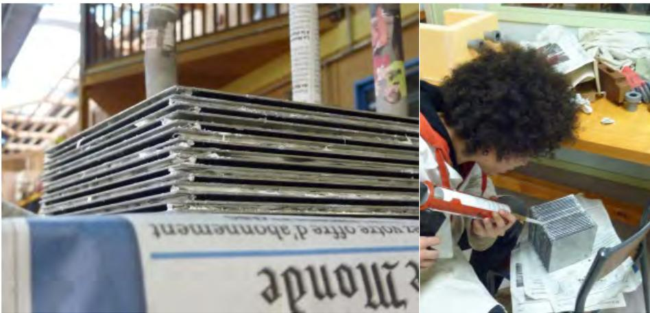
*Photographies 4 et 5 : Vue rapprochée de la tranche et isolation des interstices*
