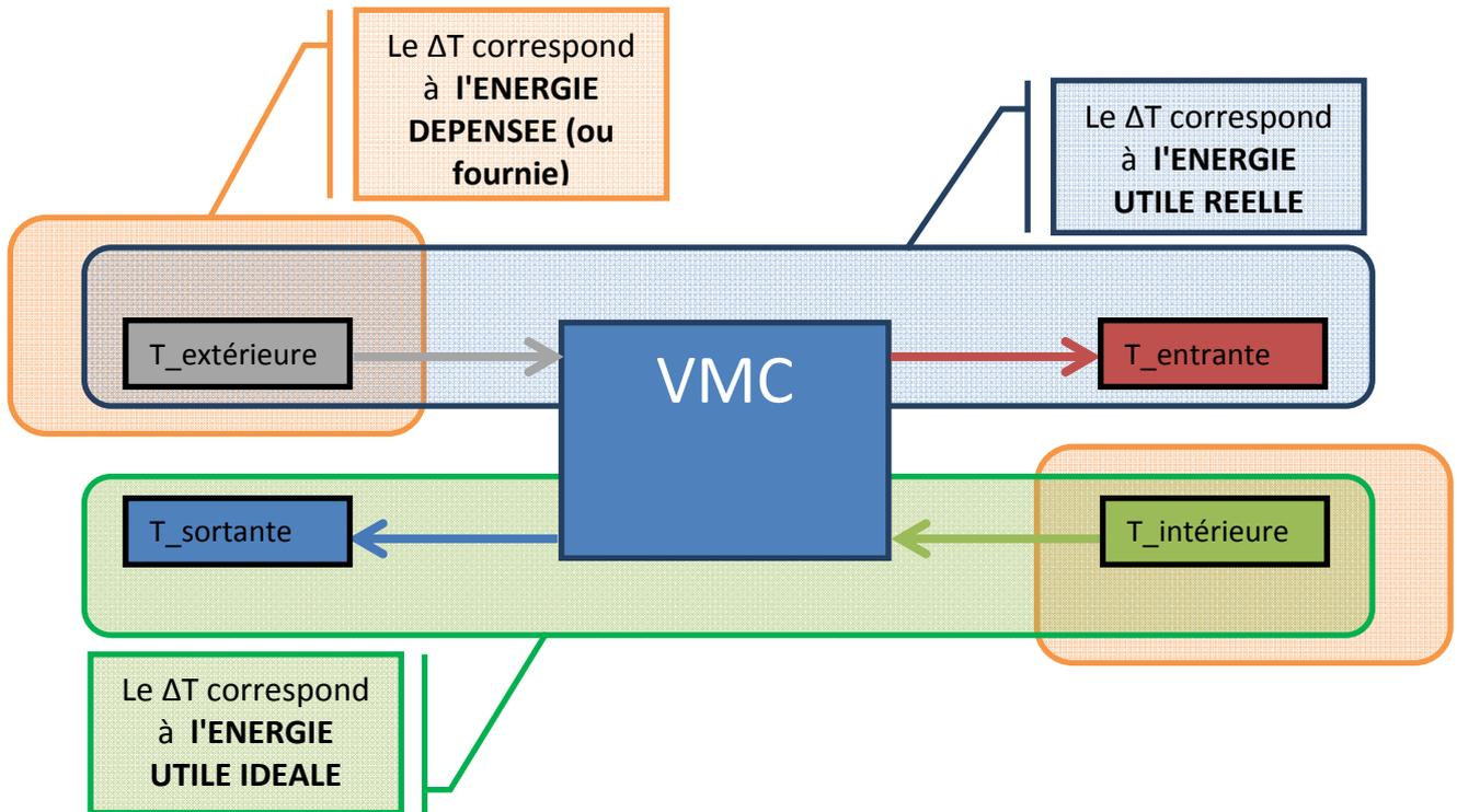
Figure 17 : Schéma des flux d'énergie dans la VMC
