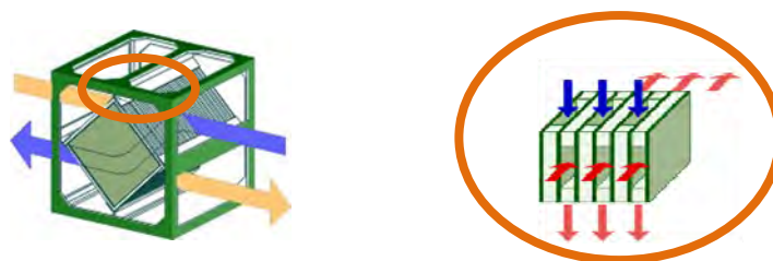
Figure 5 : Principe de fonctionnement d'un échangeur à plaques [5]
