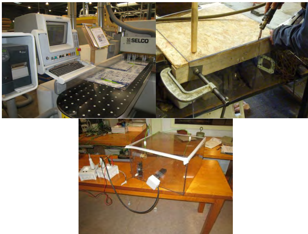
Photographies 8, 9 et 10 : Découpe, soudage et construction du « module d'habitation »
