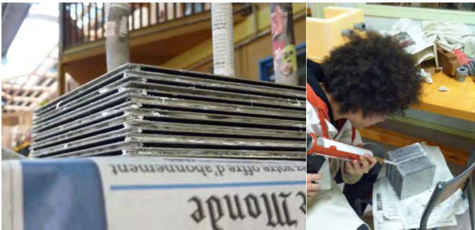
Photographies 4 et 5 : Vue rapprochée de la tranche et isolation des interstices
