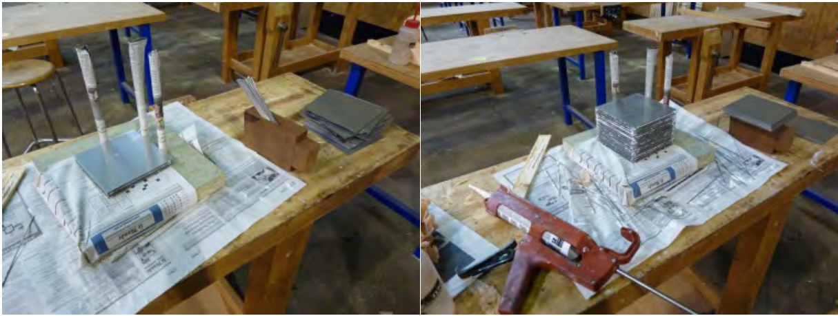
Photographies 2 et 3 : Montage de l'échangeur à plaques
