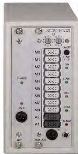
Photographie 1 : Centrale d'acquisition ALMEMO® 8690-9A [14]
