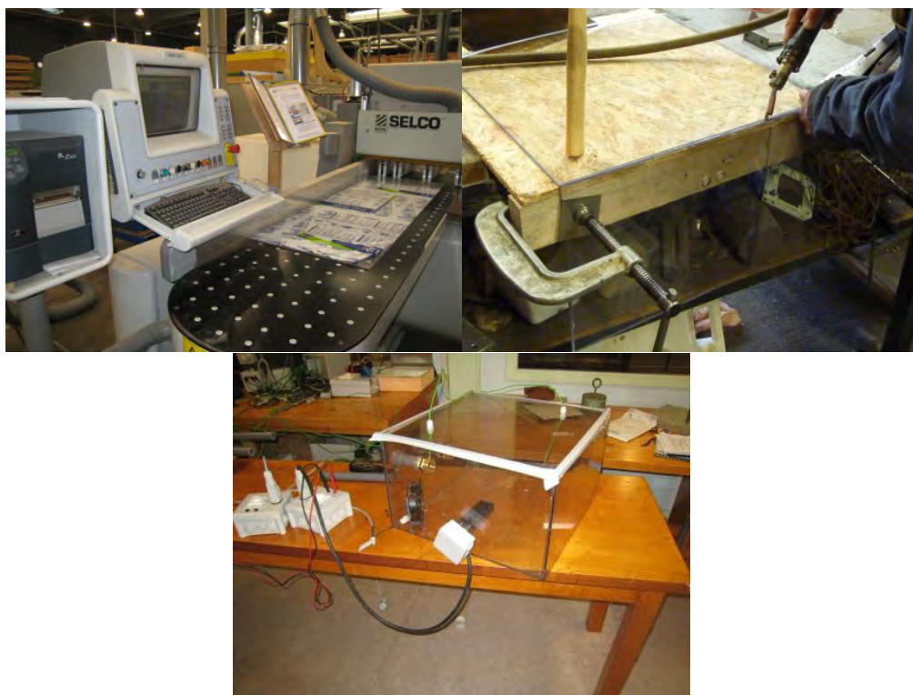
Photographies 8, 9 et 10 : Découpe, soudage et construction du « module d'habitation »
