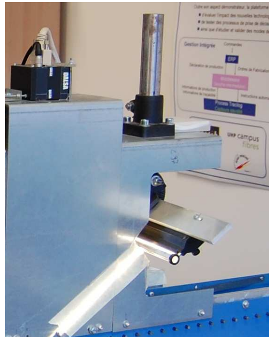
Figure 48 : Inclinaison de système d'éclairage
