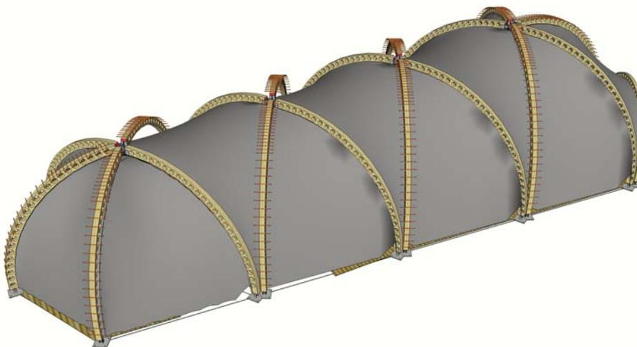
Une fois les arcs montés, il faut installer la toile intérieure. Pour se faire, on la fait passer par des glissières dans les arcs et la tire avec des treuils. Il faut impérativement la monter avant la toile extérieure car il y a besoin de monter sur les échelles.
