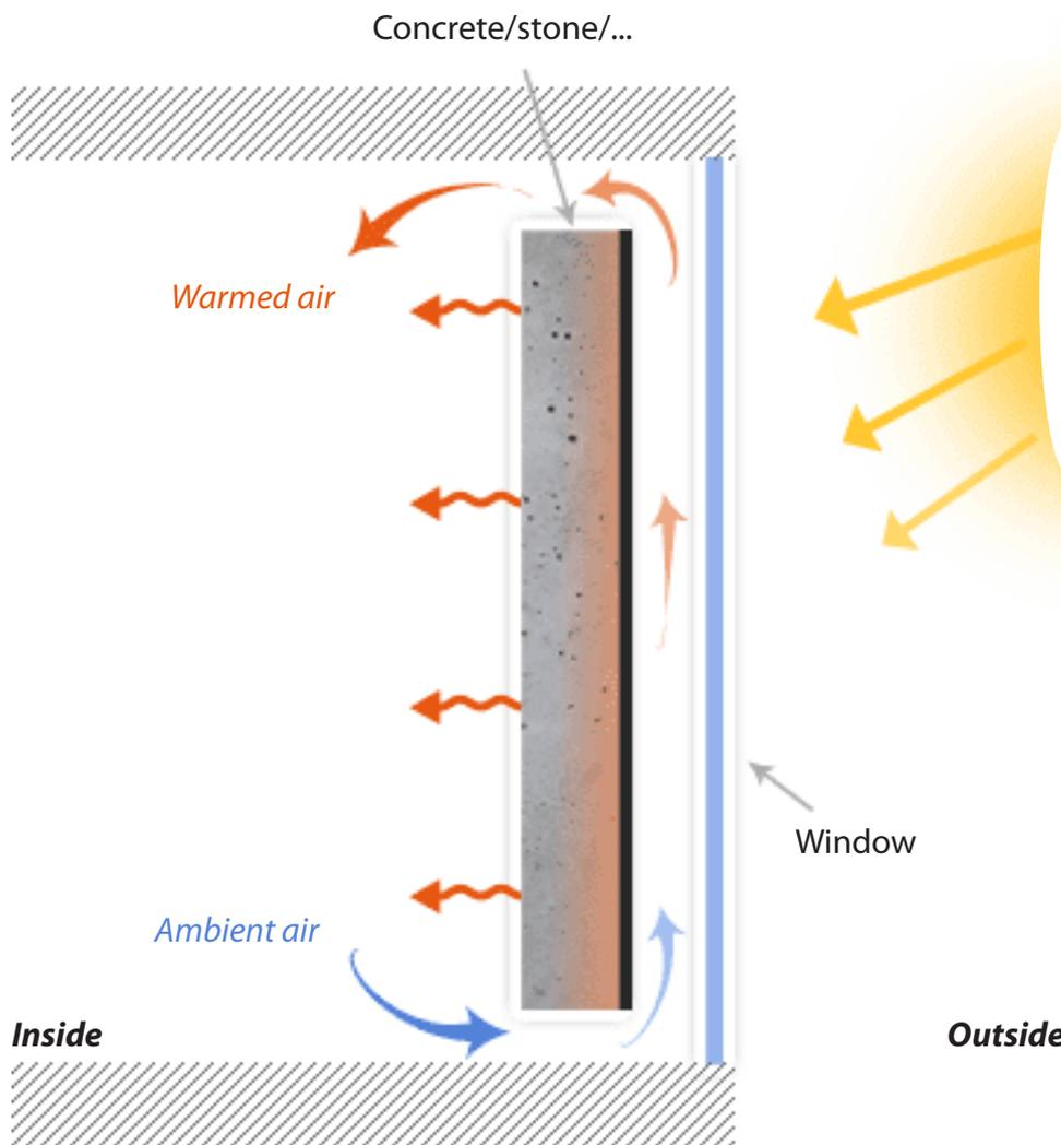
1881 - L'ingénieur Felix Trombe et l'architecte Jacques Michel développent un mur capteur constitué d'un bloc de matériau à forte inertie qui accumule l'énergie solaire durant la journée pour la restituer la nuit.
