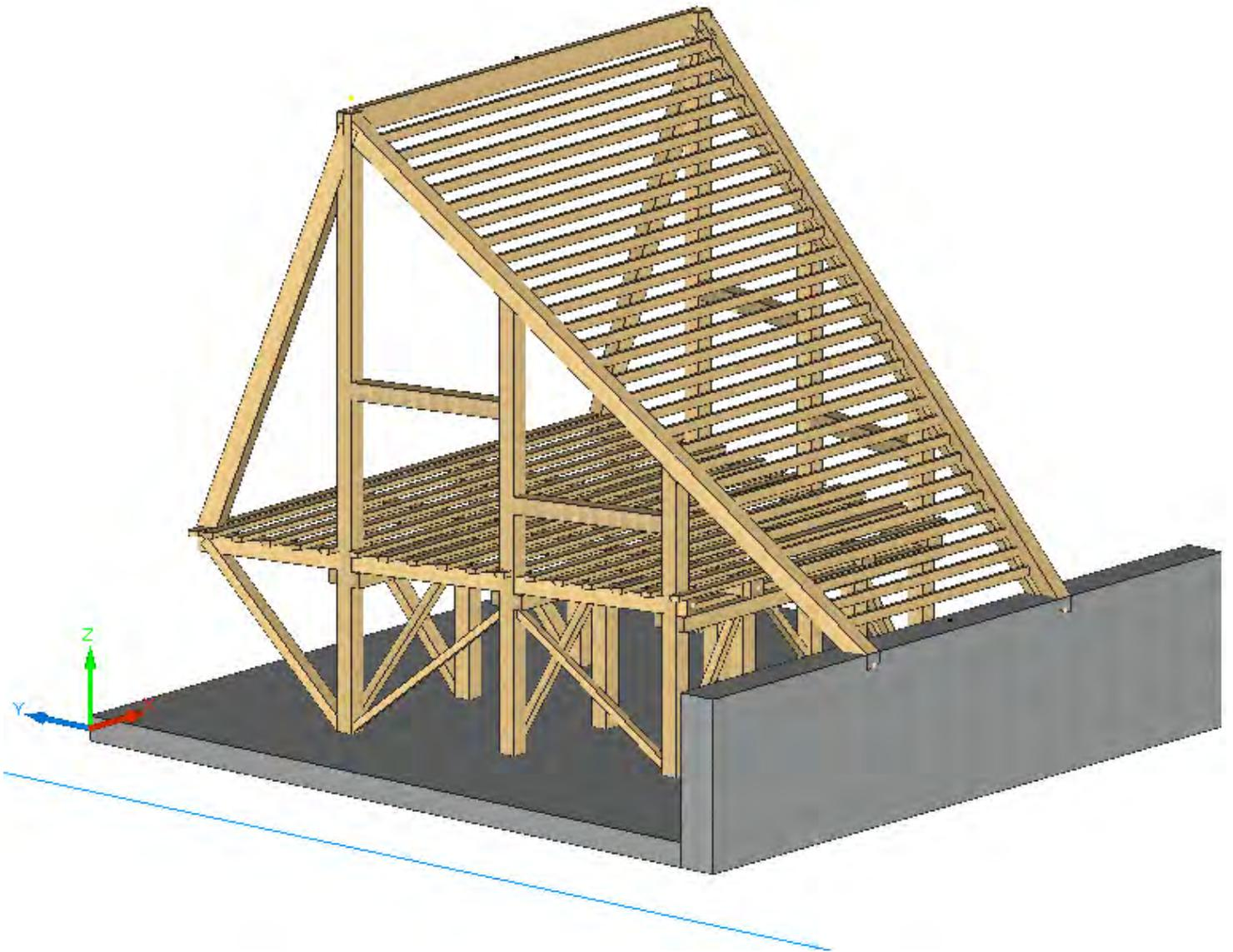
La structure est composée par un système poteaux-poutres. Le remplissage se fait par des murs à ossature bois. Le contreventement pour des vents dans la direction du long pan est assuré par une poutre au vent au niveau de la toiture qui redistribue les efforts au niveau de la façade sud et du voile béton. L'effort du vent sur le pignon est repris par les diagrammes au niveau de la façade est et ouest.
