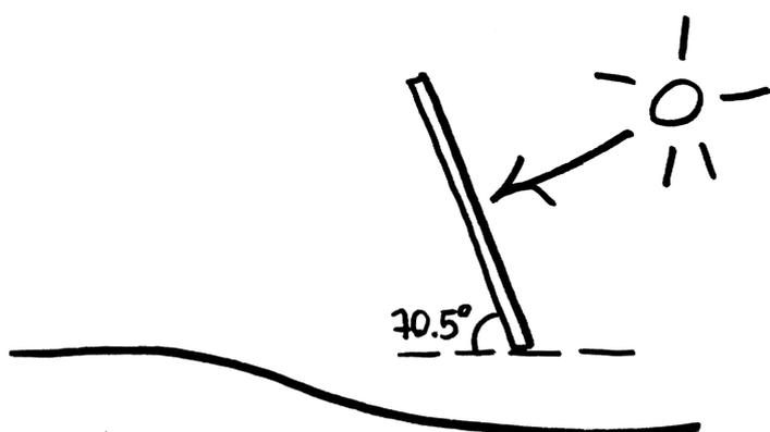
Afin de capter au maximum les rayons solaires en hiver, le mur sud est incliné perpendiculairement au soleil le plus bas.
