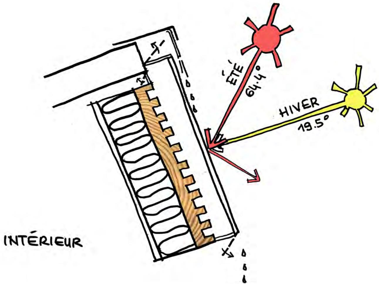
Living wall est un mur composé d'un absorbeur en bois constitué de petites lamelles ainsi que d'un verre. L'air circulant entre les deux est utilisé pour refroidir la paroi en été, tout comme l'eau qui s'écoule sur la paroi vitrée. En hiver, l'air sert cette fois-ci à rechauffer le bâtiment.
