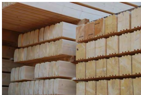
Madrier usiné stocké dans les hangar RUBNER
