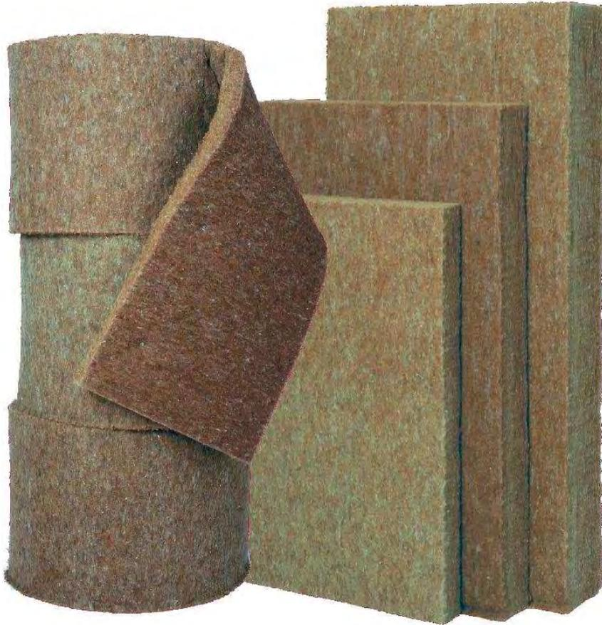
Nous nous intéressons ici à la fibre de bois car les panneaux sont fabriqués sans liant ni colle. Le bois, issu de l'exploitation des forêts et des scieries, est défibré mécaniquement. On ajoute de l'eau pour obtenir une pâte, certains panneaux d'isolation reçoivent aussi un apport d'environ 5% de fibres de cellulose. La pâte est chauffée pour que les fibres s'agglomèrent naturellement parfois compressée pour accroître la densité, puis façonnée aux dimensions commerciales.
