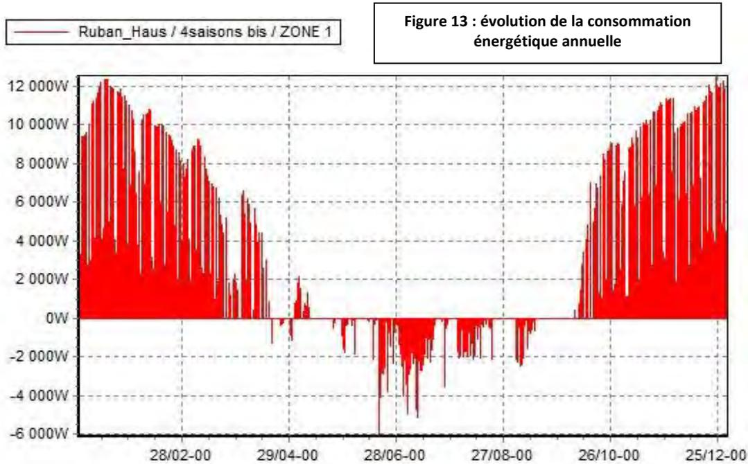
La climatisation améliore le confort d'été, du fait de la faible inertie (Simulation 3 sans climatisation : taux d'inconfort = 11.2% et température maxi = 32.9°C).
