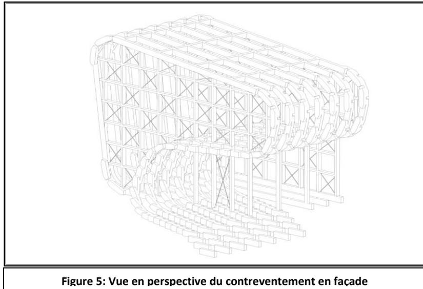
Figure 5: Vue en perspective du contreventement en façade
