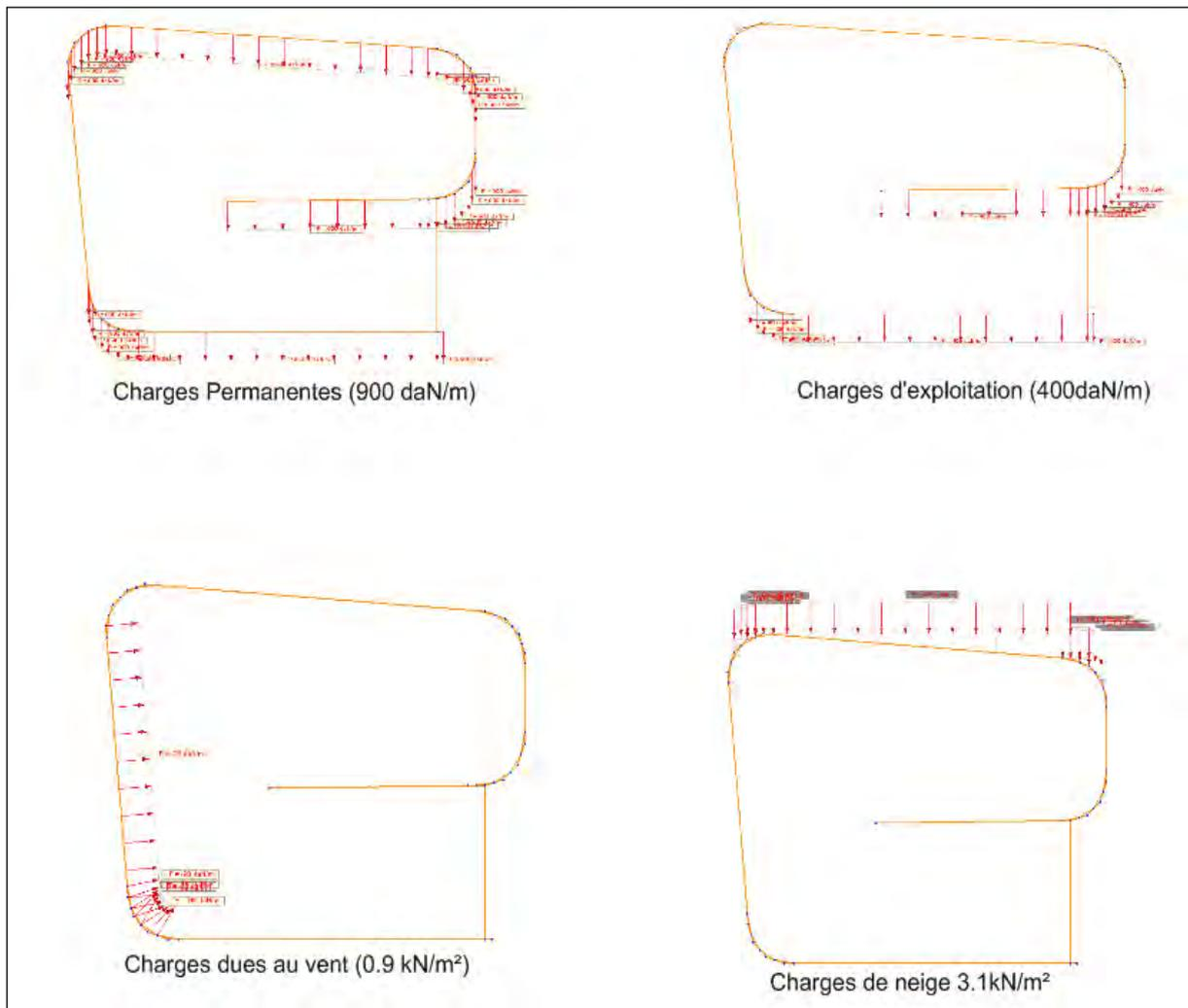
Figure 7 : Charges modélisées pour le pré-dimensionnement
