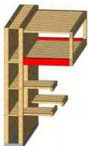
Solive de rive du plancher : par l'intermédiaire des murs cette poutre reprend la moitié des charges s'appliquant sur la toiture, le poids des murs, son poids propre, ainsi que les charges d'exploitation du plancher.
