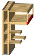
Poutre ramasse-solive : elle reprend les charges de la moitié du plancher du show-room et son poids propre.
