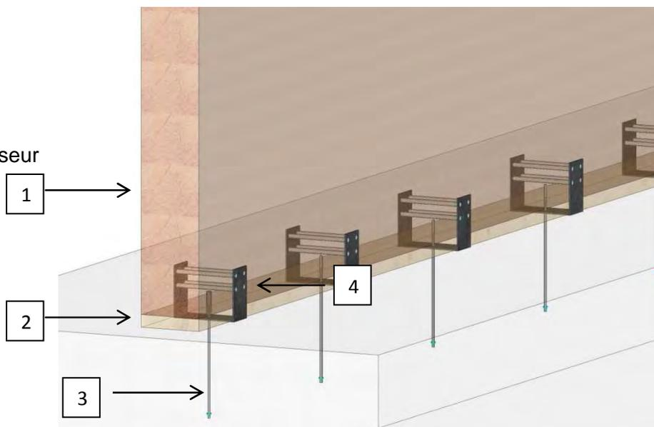
Les goujons de 10 mm de diamètre en acier de qualité S235 résistent à l'arrachement.
