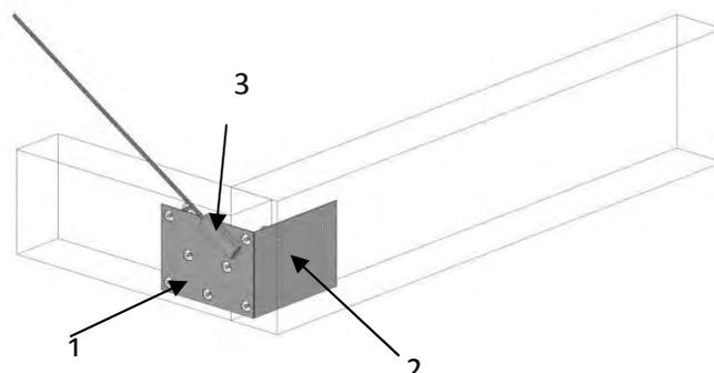
La partie 1 de la platine doit avoir une épaisseur de 3 mm, la partie 2 de 2mm, et la partie 3 de 38 mm. Les pinces de percement ont été vérifiées avec l'EC3 et l'EC5.
