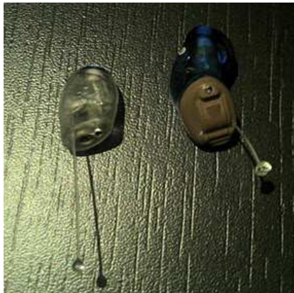
Photo 16 : S Series 11 IQ dont l'insertion est profonde à gauche, et dont l'insertion est normale à droite
