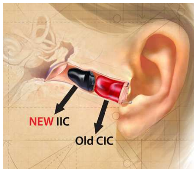
Figure 9 : Mise en place d'un CIC et du SoundLens [7]
