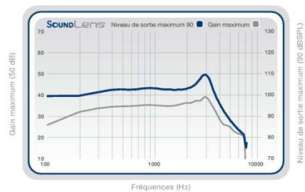
Courbe de niveau de sortie maximum (bleu) et Gain maximum (gris). Matrix 110/40.
