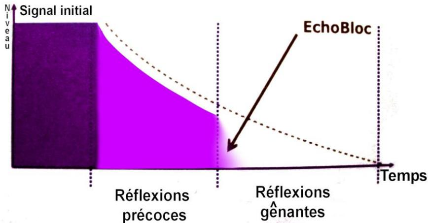
**Figure 2.3** Zone d'application du système EchoBloc [13]
