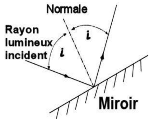
Figure 1.4 Loi de Descartes en optique [5]
