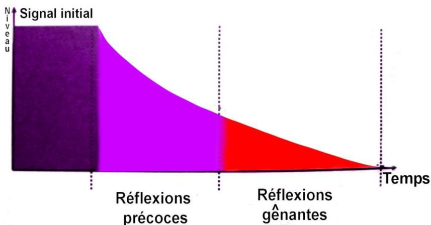
Figure 2.2 Signal réverbéré perçu par l'aide auditive [13]
