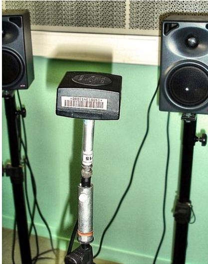
**Figure 3.2** Mise en place du pistonphone pour l'étalonnage
