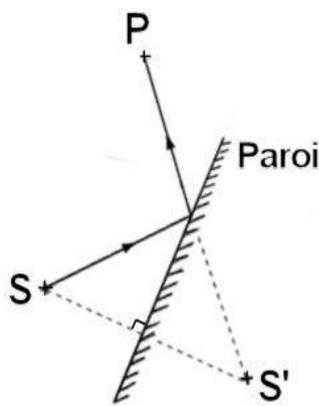
Figure 1.5 Réflexion spéculaire et source image [5]
