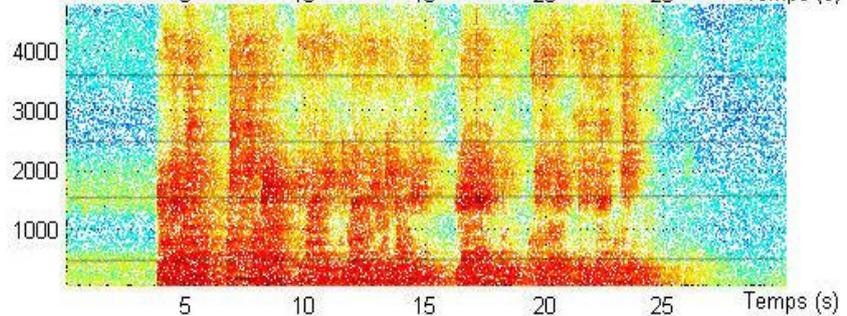
**Figure 3.11** Zoom sur le spectrogramme d'un signal de parole réverbéré avec un TR=3s
