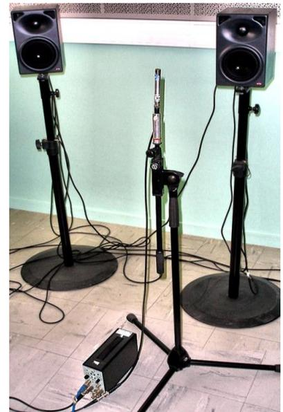
**Figure 3.1** Installation du microphone demi-pouce
