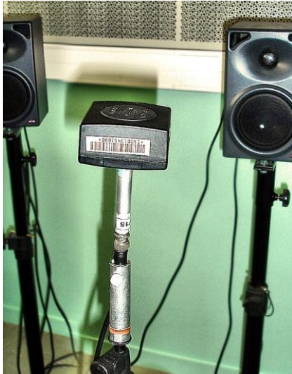
Figure 3.2 Mise en place du pistonphone pour l'étalonnage
