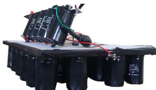
Figure B.1 – Les condensateurs
