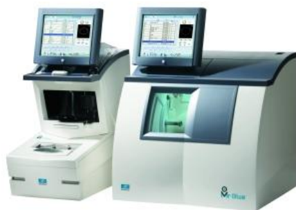
Mr Blue, la chaîne numérique comprenant un lecteur-centreur-bloqueur et une meuleuse.
