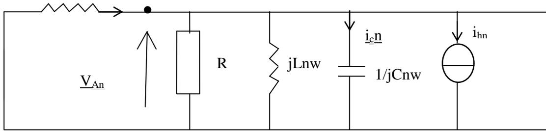
**Figure 13 :** Schéma monophasé du réseau pour le rang n.
