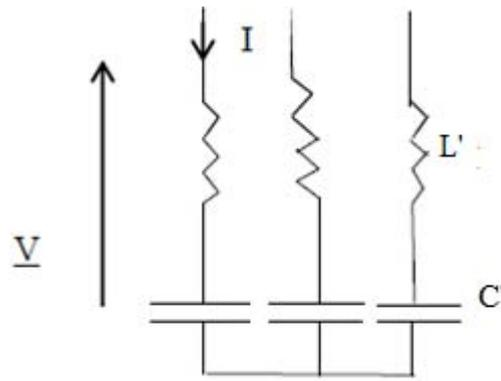
**Figure 15 :** Schéma d'un filtre passif.
