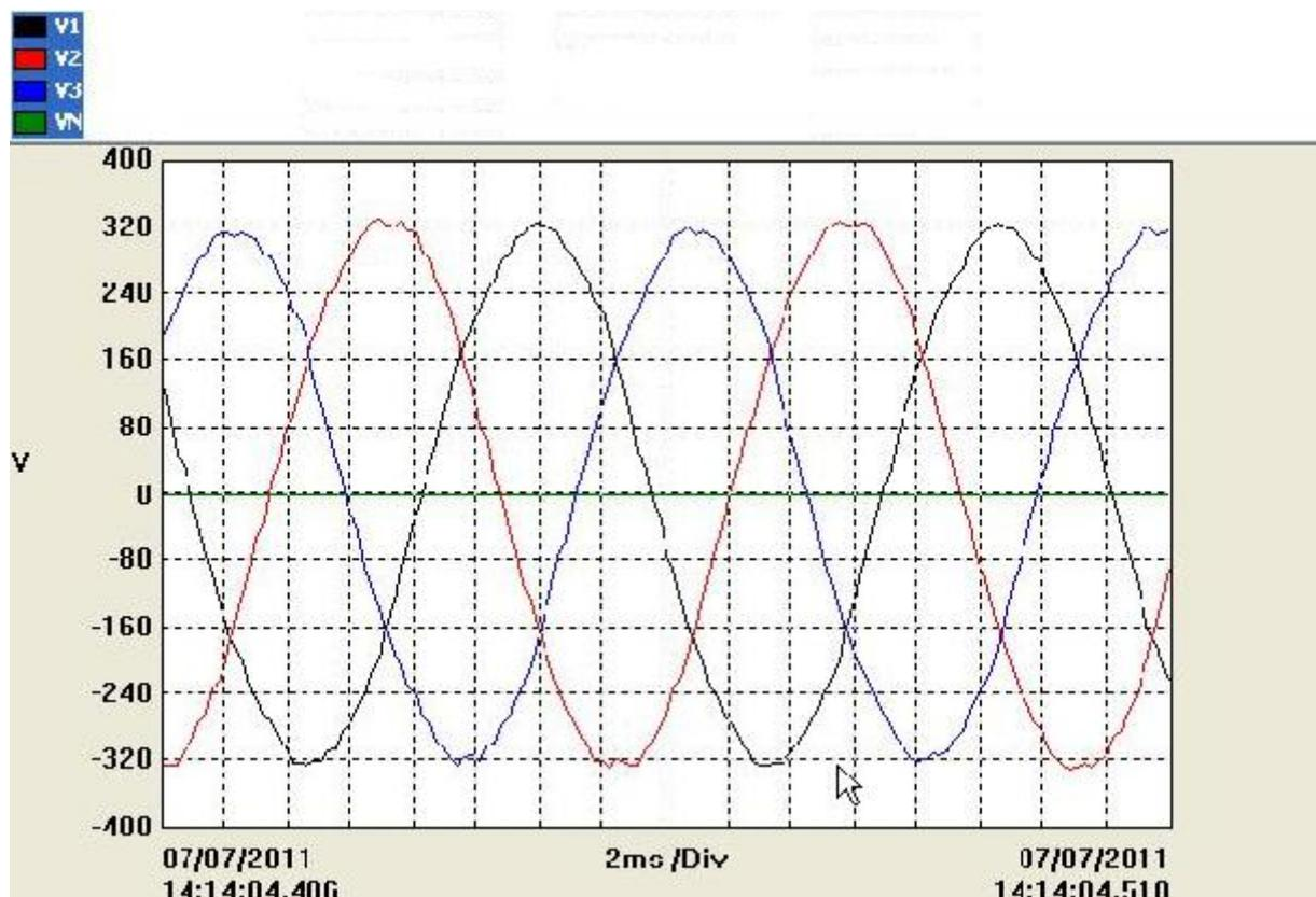
**Figure 3:** Sinusoïde de la tension de phase.
