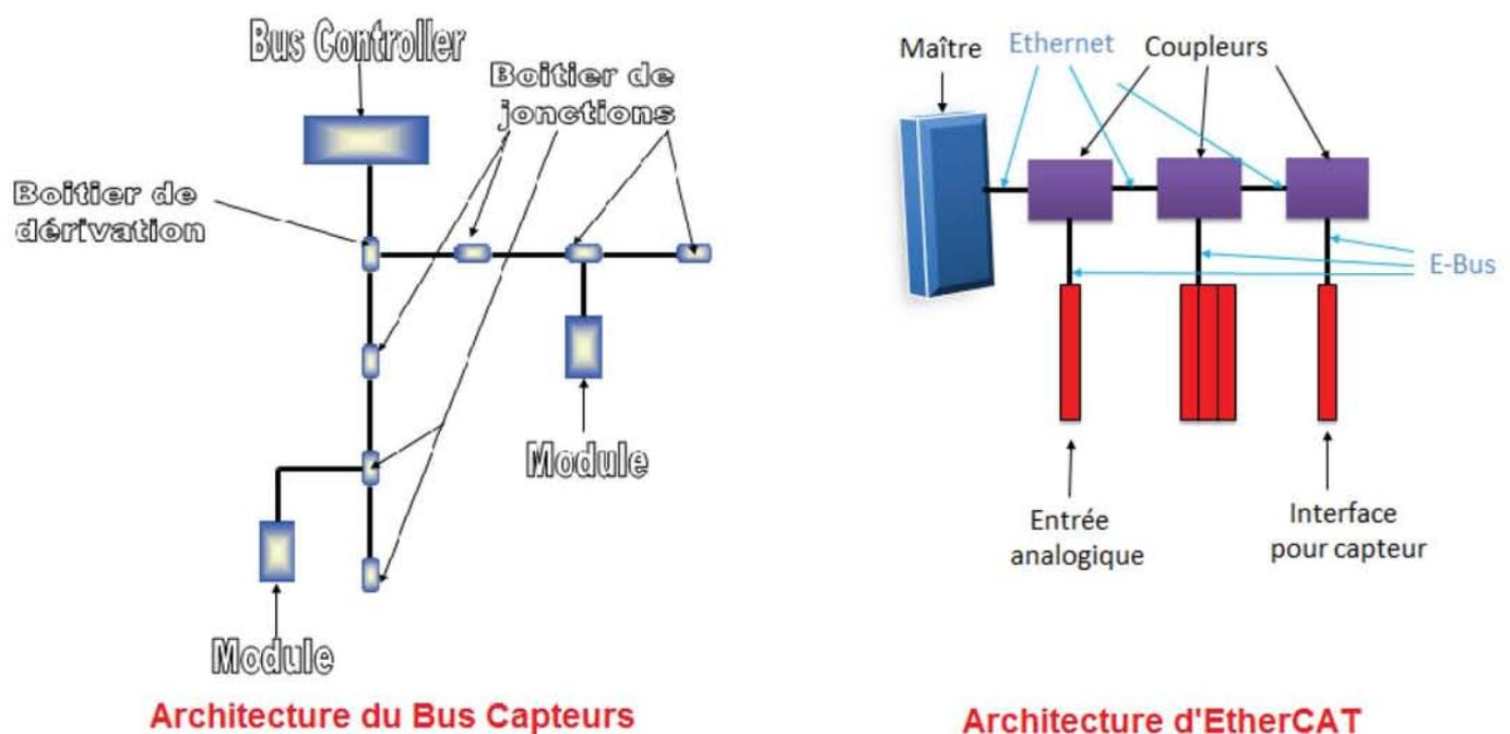
Figure 5 : Architecture du Bus Capteurs vs EtherCAT.
