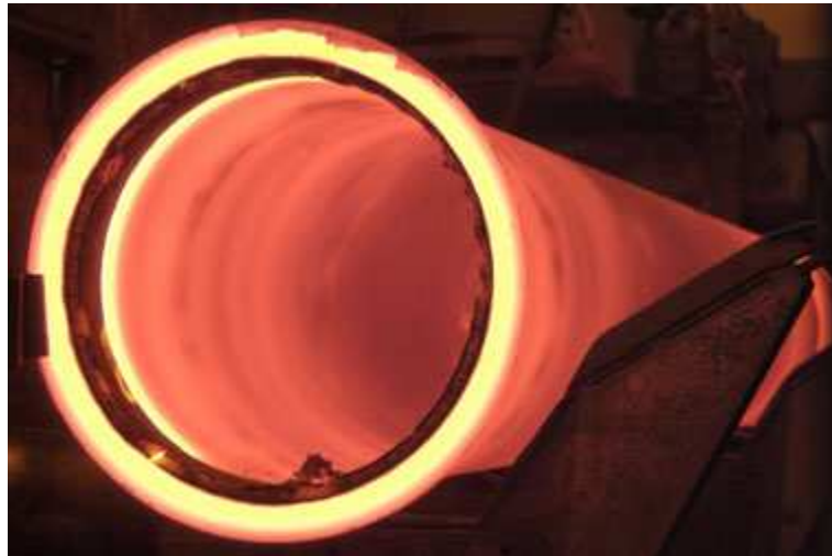
Figure 1.4 : Centrifugation de tuyau en fonte ductile de grand diamètre
