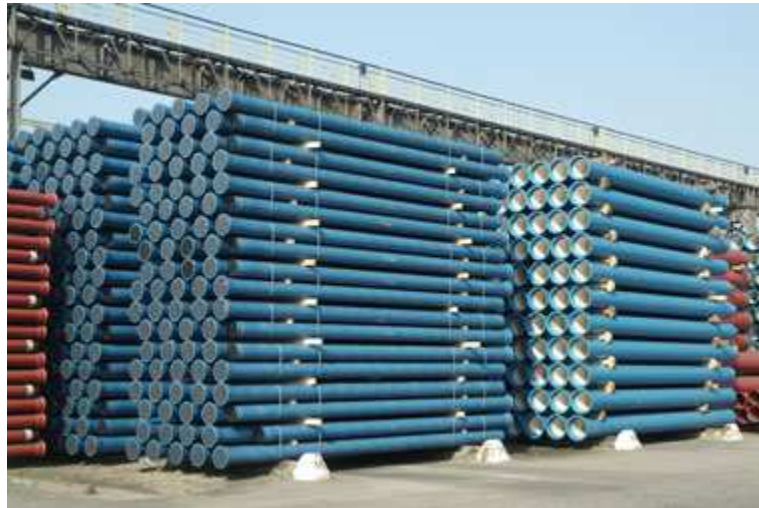
Figure 1.2 : Parc de stockage de tuyaux en fonte ductile
