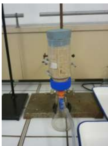
Figure 6 : Dispositif d'extraction et de filtration de solution du sable par dépression
