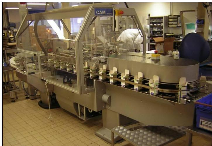
**Encartonneuse ou CAM**
