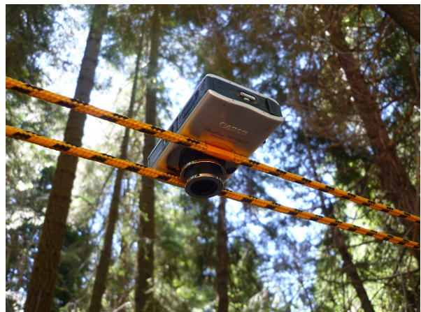
Figure 8b. Photographie montrant l'installation de l'appareil photo visant le sol sur la corde tendue.
