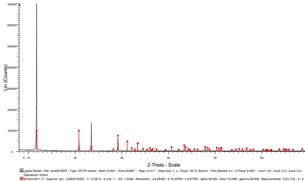
**Figure 4:** *Diffractogramme de rayons X du Gypse Riedel*
