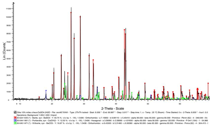
Figure 6: diffractogramme du précipité Gypse + SP1 à 10% + CaO : présence de BaCO<sub>3</sub>
