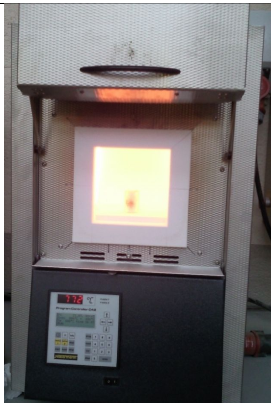
Figure 5 : Four à 700°C : Elimination du superplastifiant dans les filtres obtenus
