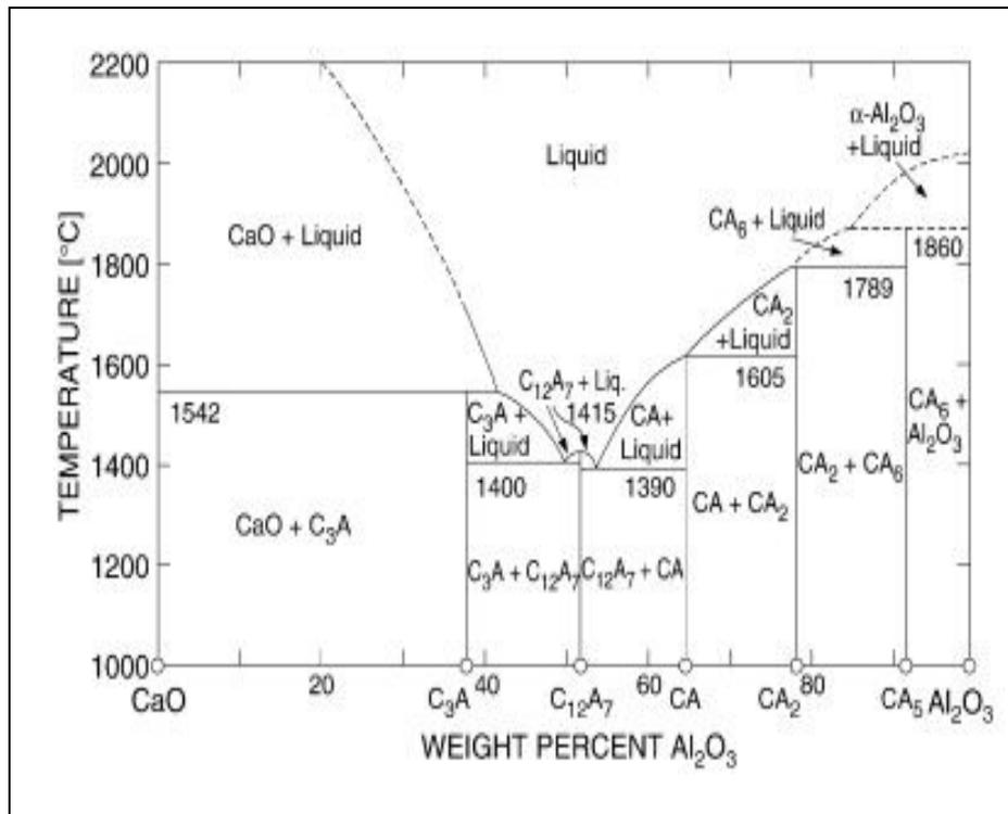
**Figure 2** : Diagramme de phase du système binaire  $CaO-Al_2O_3$ [4]
