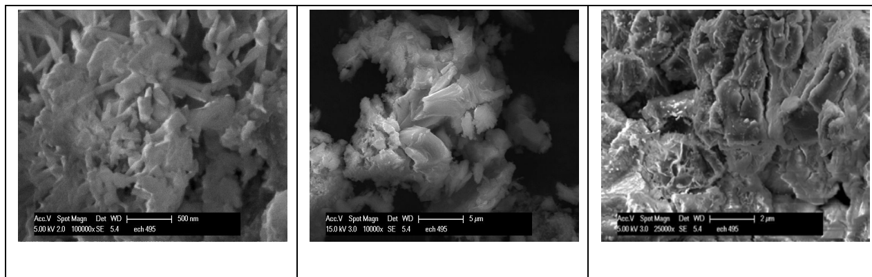
Figure 27 : Micrographies du mélange C_3A cubique + CaSO_4 après 15 min d'hydratation dans de l'eau distillée
