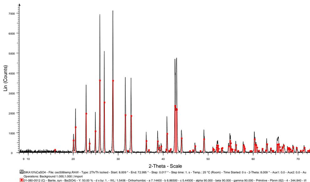
**Figure 9 :** diffractogramme du précipité obtenu à partir de CaSO<sub>4</sub> en présence du superplastifiant SP1
