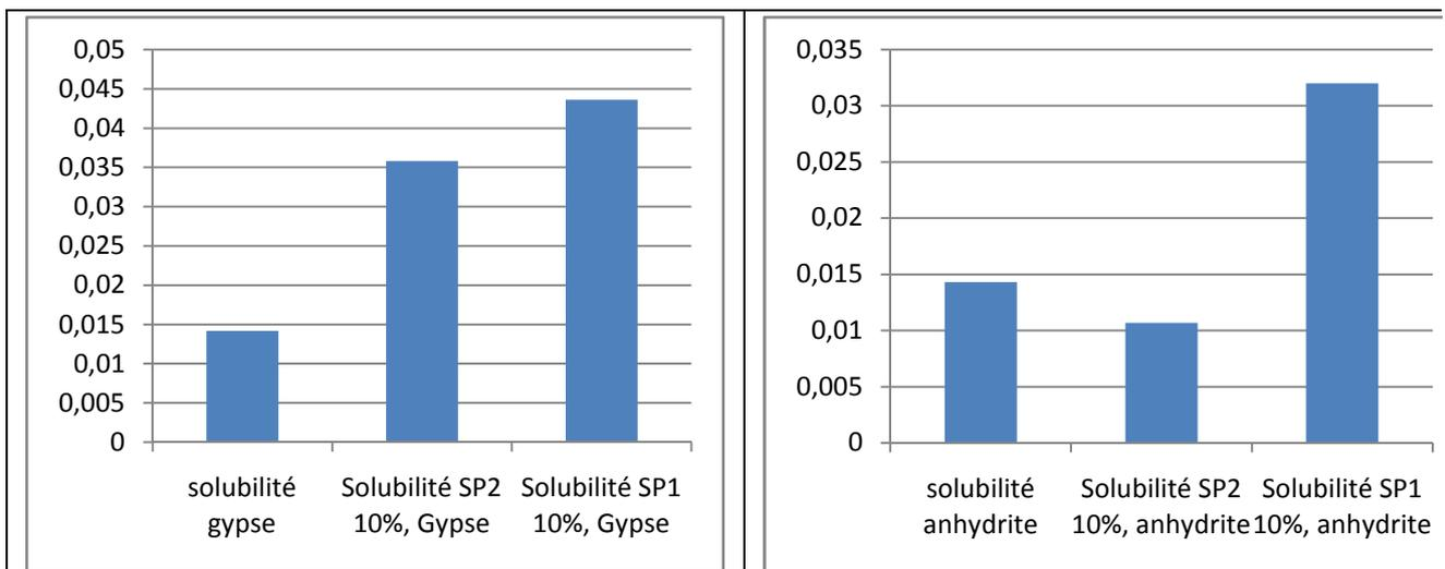
**Figure 13** : Influence des superplastifiants sur la solubilité des sulfates en milieu neutre
