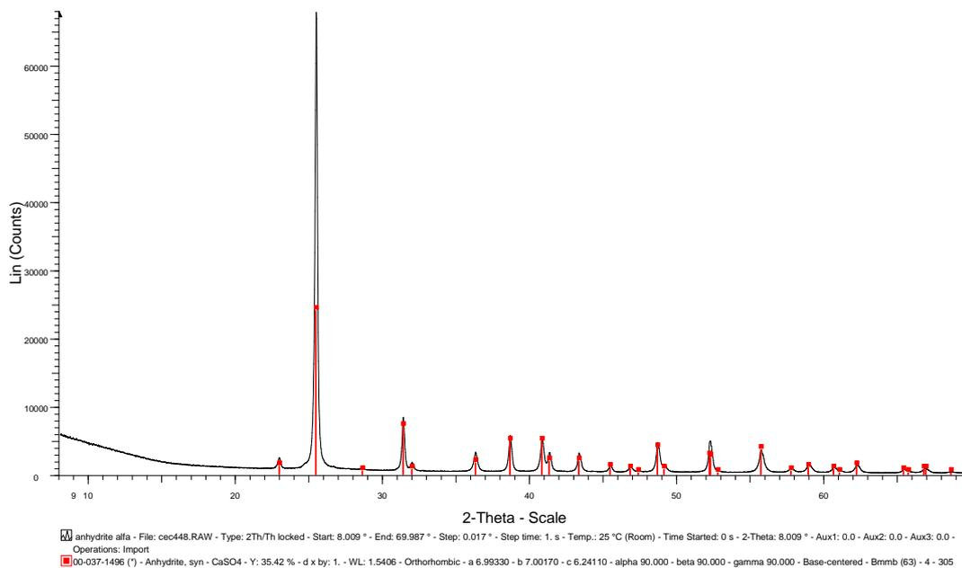
**Figure 3:** *Diffractogramme de rayons X de l'Anhydrite Alfa*
