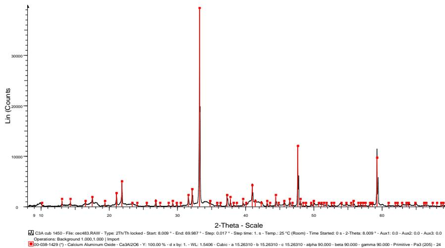
**Figure 21:** Diffractogramme de la phase aluminat cubique C<sub>3</sub>A recuit 3 fois à 1450°C°
