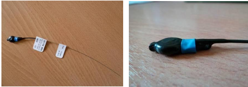
Emetteur, avec son antenne. Pile protégée par un scotch évitant son fonctionnement.
