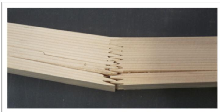
Photo 7 : Rupture par arrachement des fibres
