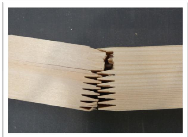
Photo 6 : Rupture de bloc
