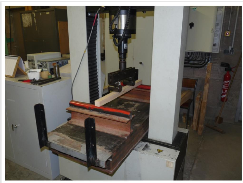
Photo 10 : Banc d'essai recevant des éprouvettes de grande longueur
