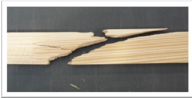
Photo 8 : Rupture hors du joint de colle
