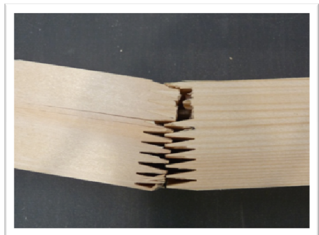
Photo 6 : Rupture de bloc
