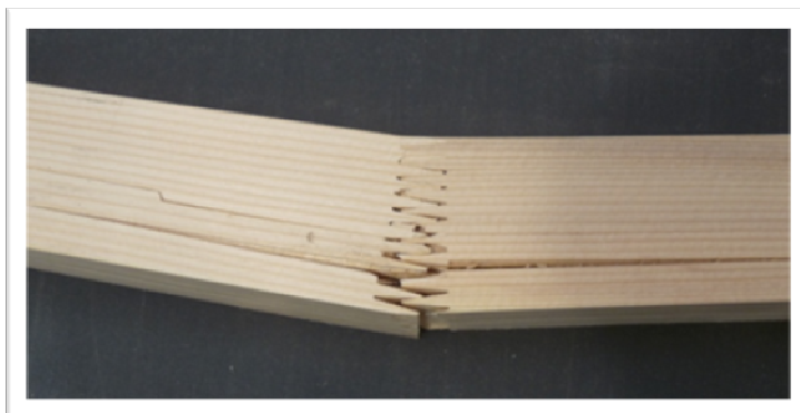
Photo 7 : Rupture par arrachement des fibres
