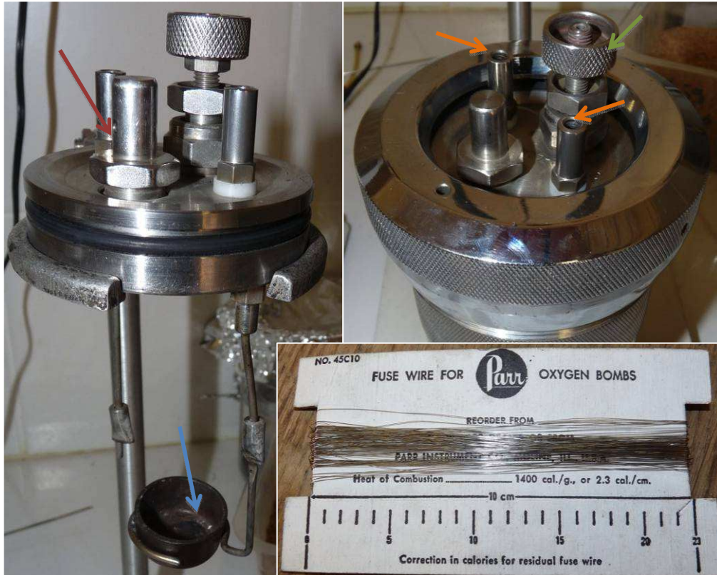
Figure 19 : Bombe calorimétriques et accessoires (photo B.Cluet)
