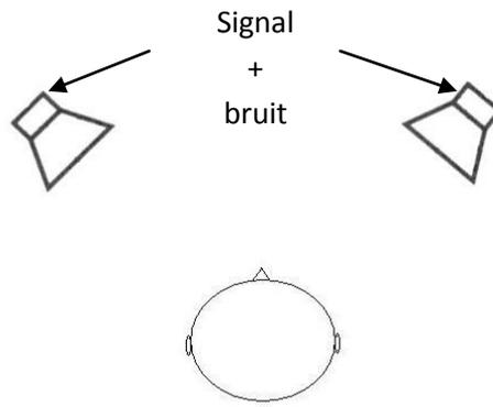
Figure 15 : Schéma présentant la situation du test de compréhension dans le bruit
