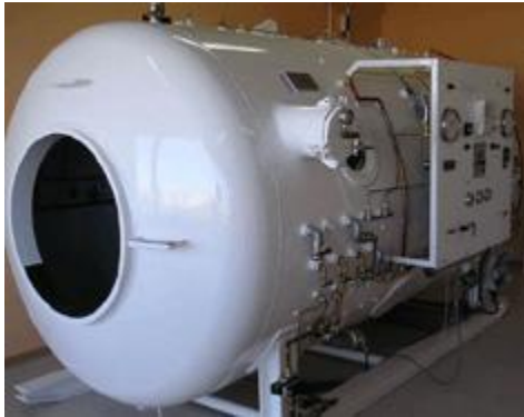
Figure II-12 Photo d'un caisson de décompression appelé également caisson hyperbare [6]
