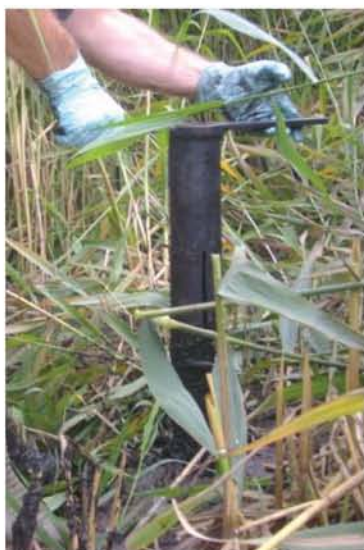
Figure 14 : Prélèvement de la boue du casier
