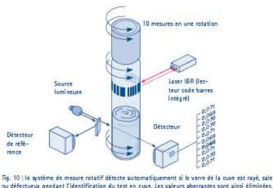
Figure 17 : Cuve test Lange (source : rapport d'application Lange)
