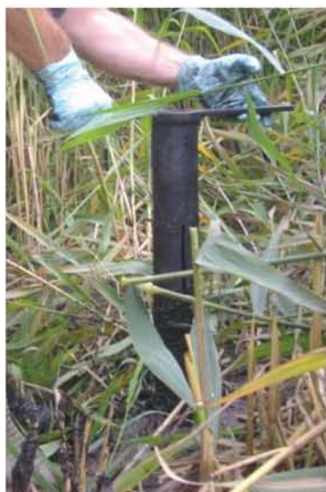
Figure 14 : Prélèvement de la boue du casier
