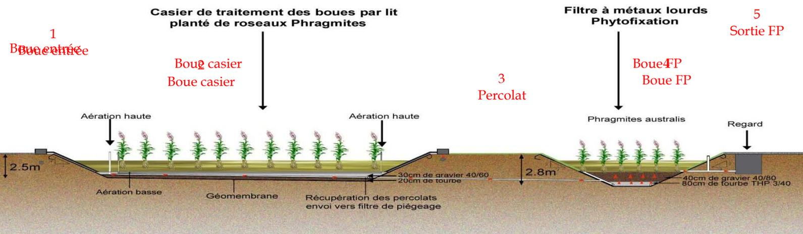
Figure 11 : Coupe transversale de Jardins Filtrants® boues et du Filtre de Piégeage® avec les points de prélèvement de l'étude (source Phytorestore)
