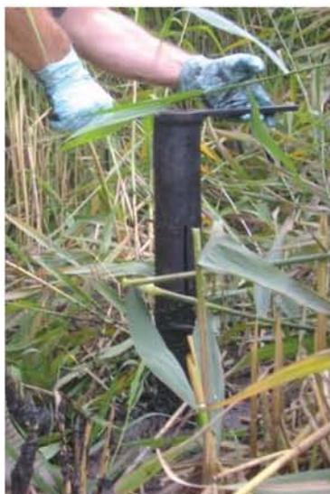
Figure 14 : Prélèvement de la boue du casier
