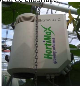
Figure 4: Sonde de température d'air ventilée «EKTRON»
